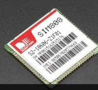
SIM808 GSM + GPRS + GPS
